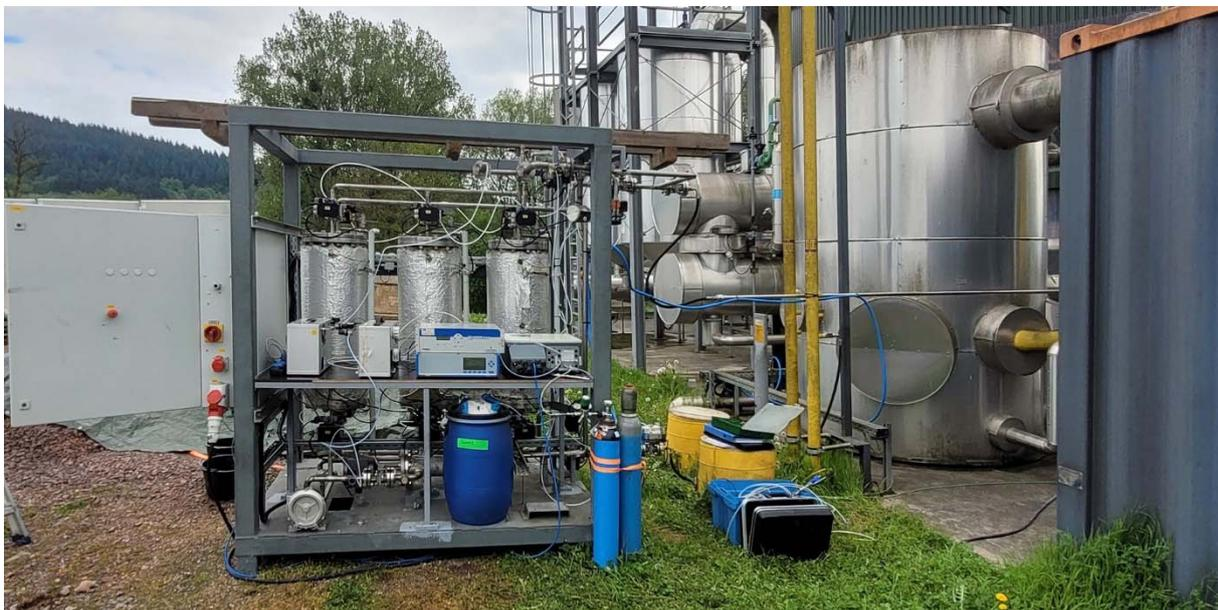
**Abb. 1:** Mobile Adsorptions-Versuchsanlage, installiert an der Biogasanlage der NatürlichEnergie EMH GmbH (Platten, Rheinland-Pfalz).
