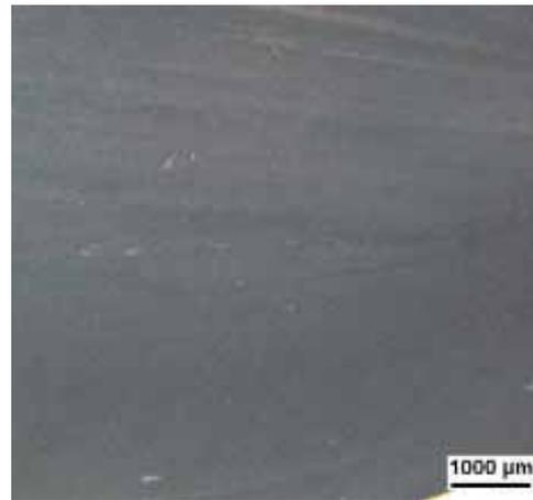
**Bild 3.83:** PVDF:Graphit 35 Vol.% nach Spritzguss
