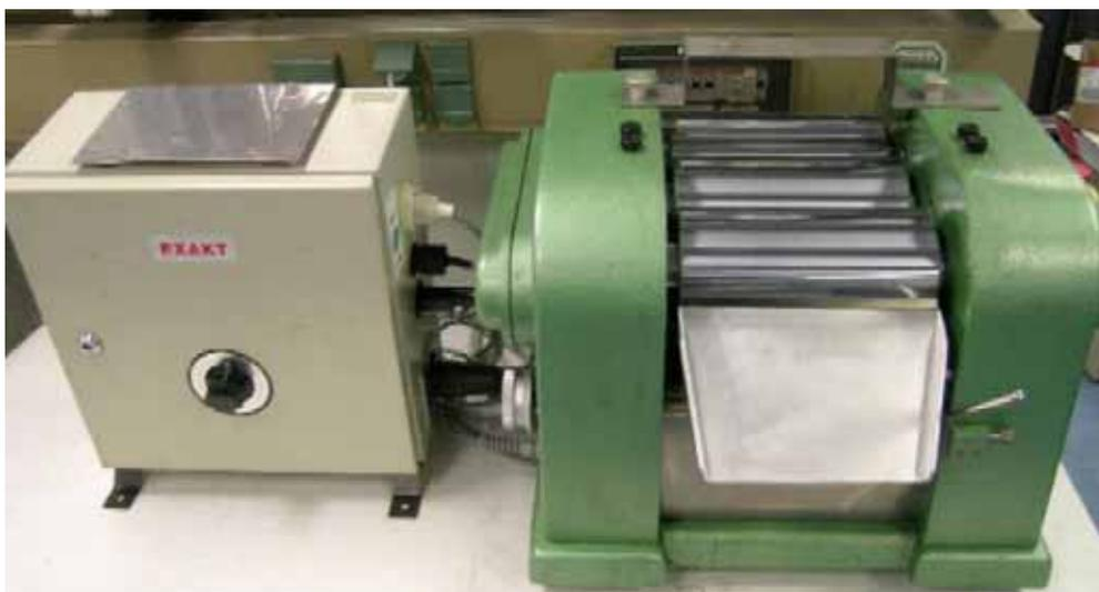
**Bild 3.63:** Dreiwälzwerk (im Bild ohne Thermostat)
