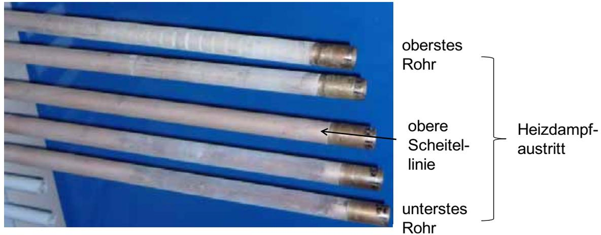
**Bild 3.20:** Fotoaufnahme des Belags auf Rohren aus Kupfer-Nickel 90/10 nach einer Versuchsdauer von 58 h
