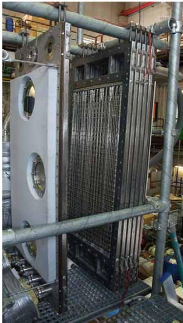
**Bild 3.39:** Fotografie Platten-Fallfilmverdampfer mit Polymerfolien
