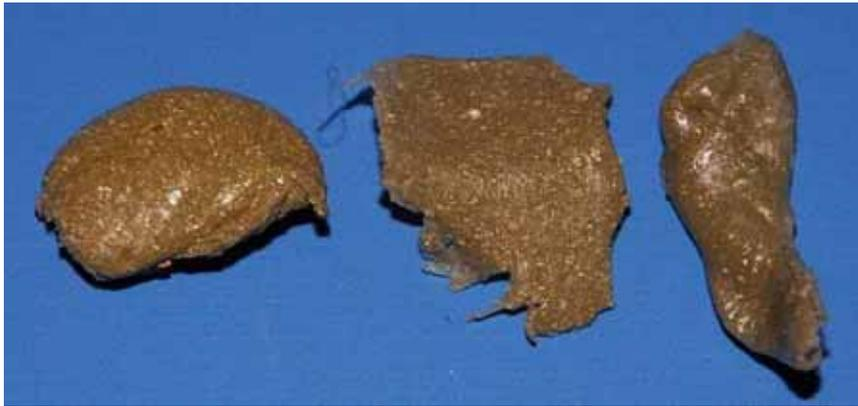
**Bild 3.68:** PE-HD:Ag Komposite aus Ethanol suspension mit 4,2 – 2,9 – 1,9 Vol.% Ag
