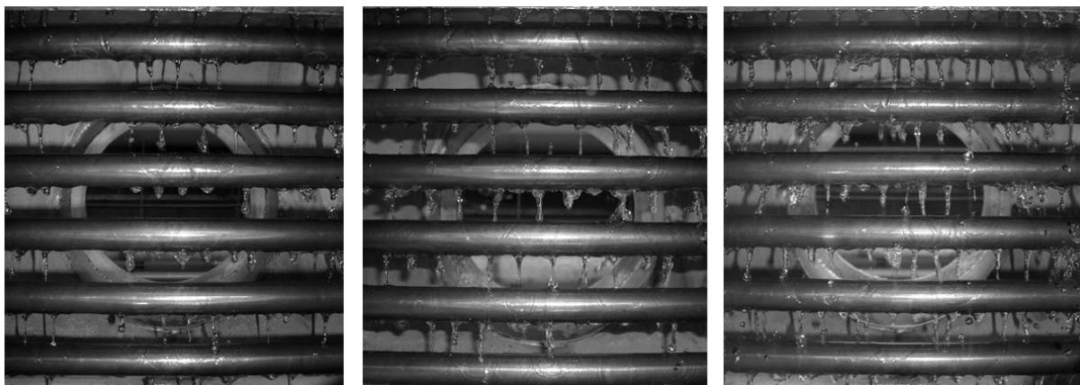
**Bild 3.10:** Kupfer-Nickel-Rohre bei  $\Gamma = 0,031$  kg/(m s) (links),  $\Gamma = 0,054$  kg/(m s) (Mitte),  $\Gamma = 0,074$  kg/(m s) (rechts) bei schrittweiser Erhöhung der Berieselungsdichte
