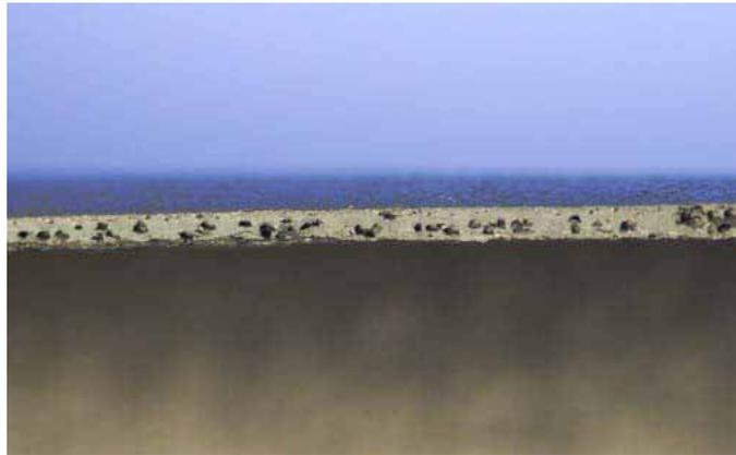
**Bild 3.100:** Lufteinschlüsse in Rohrcharge 2, Längsschnitt, Detail
