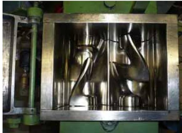
**Bild 3.91:** Doppelschaufelknetkopf (5 L)
