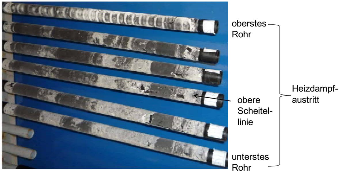
**Bild 3.22:** Fotoaufnahme des Belags auf Rohren aus ungefülltem PE-HD nach einer Versuchsdauer von 58 h
