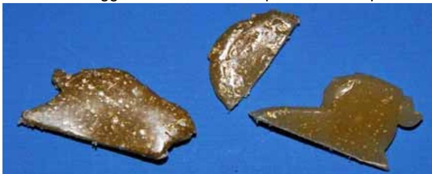
**Bild 3.67:** PE-HD:Ag Komposite mit 4,2 – 2,9 – 1,9 Vol.% Ag
