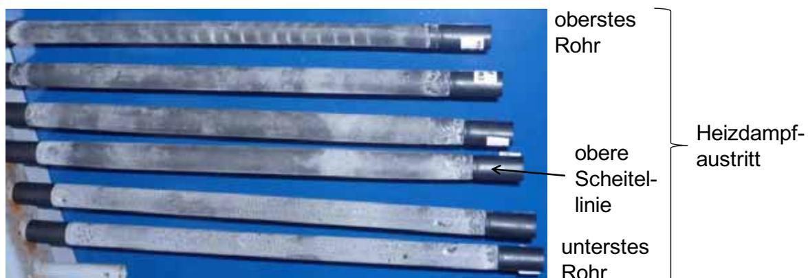
**Bild 3.24:** Fotoaufnahme des Belags auf Rohren aus Komposit I nach einer Versuchsdauer von 58 h
