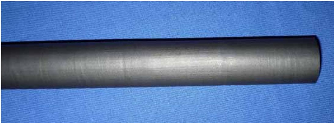
**Bild 3.96:** Extrudiertes Rohr mit Einschnürungen
