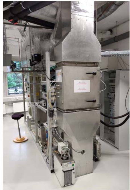
Abbildung 5-2: Schematische Darstellung des modifizierten Kfz-Filterprüfstandes und Foto des Prüfstandes
