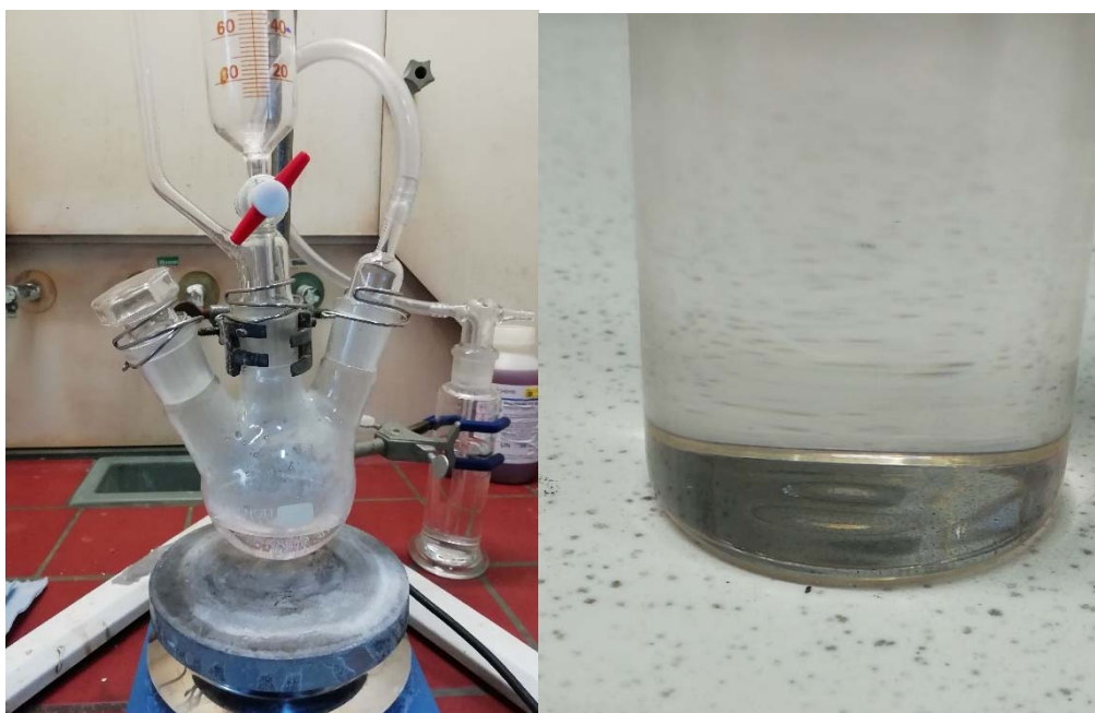
Abbildung 4 Versuchsaufbau für Lösungsversuch mit DMF, und Niederschlag im Glaskolben.
