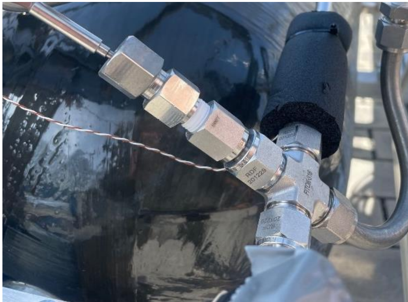
Abbildung 11: Nachgerüstete Messstelle 22 am 35 MPa Testtank
