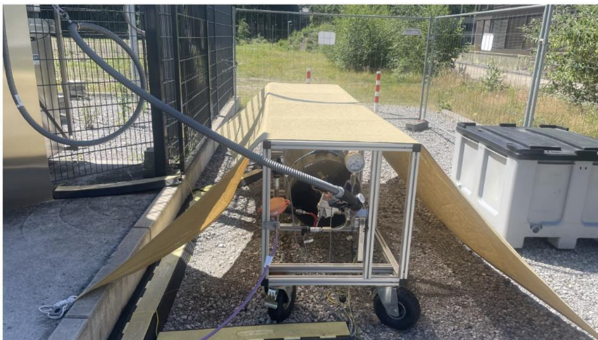
Abbildung 4: Fahrzeugtank mit angeschlossener Kupplung
