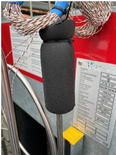
Abbildung 10: Nachgerüstete Messstellen am Hochdruckspeicher (Segmente 6-7)
