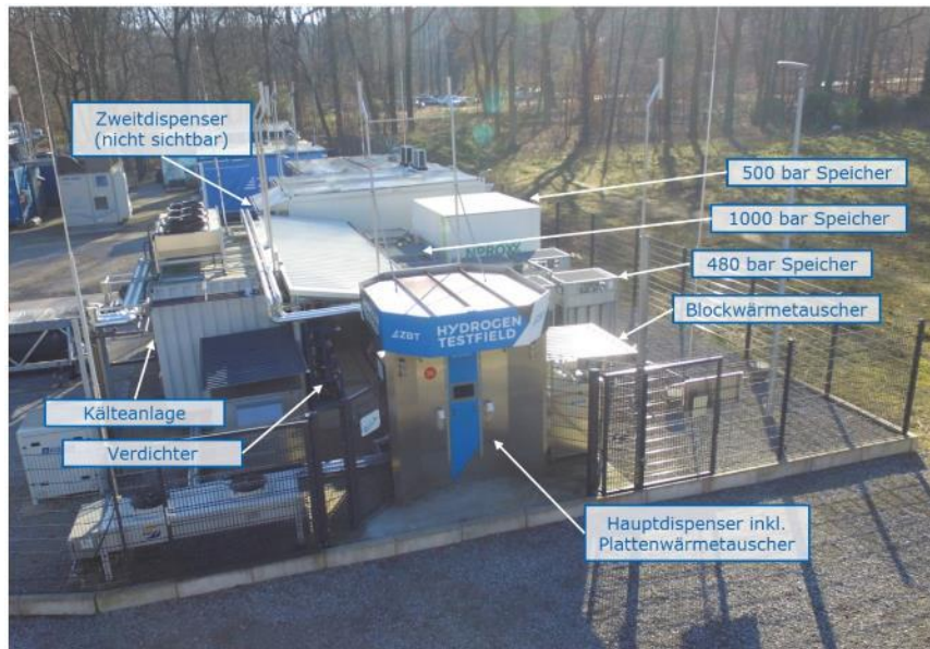
Abbildung 2: Anordnung der Komponenten im Hochdruckteststand
