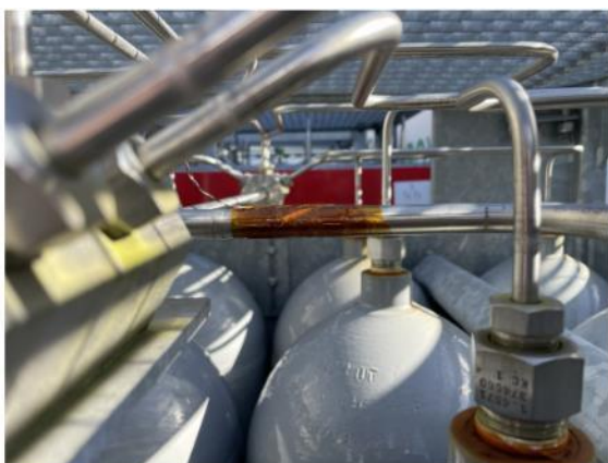
(a) Thermoelement zwischen Kaptonbandschichten
