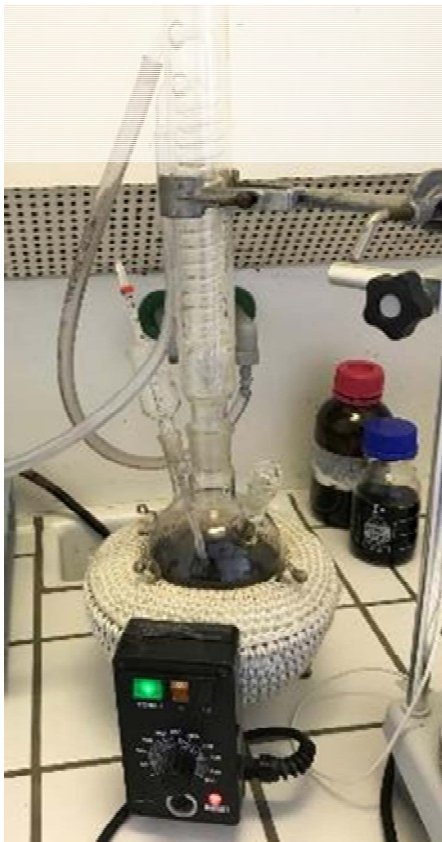
Abbildung 17 Apparatur zur Synthese des Ru-Grundelektrolyten
