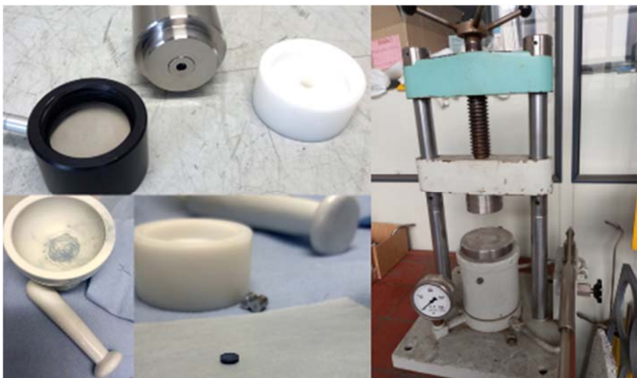
Abbildung 12 oben links: Presswerkzeug zur reproduzierbaren Fertigung von Presslingen. Rechts: Einstellbare hydraulische Presse, die ermöglicht, gezielt Druck auf das Presswerkzeug auszuüben. Unten links: Mörser zur Homogenisierung des Materials und fertiger Pressling.
