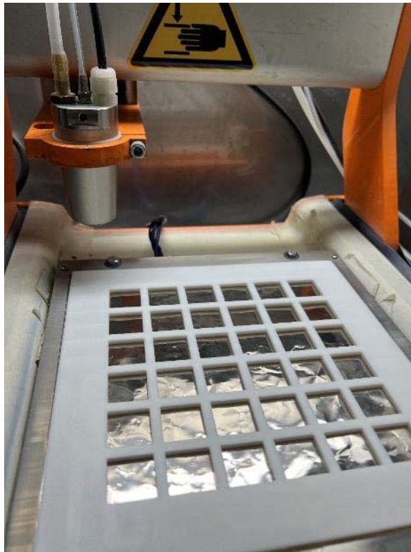
Abbildung 27: Ultraschall-Sprühvorrichtung für die Beschichtung von Titan-PTL
