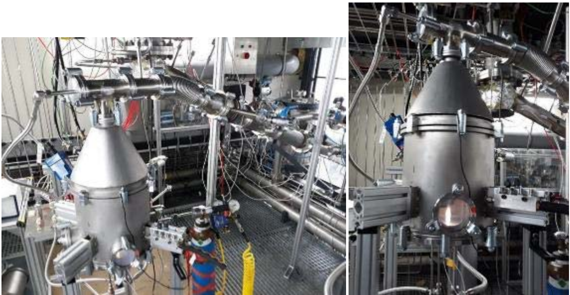
Abbildung 2: Verbrennungsreaktor im IUTA Technikum zur Herstellung von Nanopartikeln. Links: Gesamtansicht des Reaktorsystems inklusive Abgasstrang und rechts: Detailansicht des Reaktors mit brennender Flamme.
