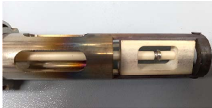
Abbildung 13: Vorrichtung zur Kontaktierung von Presslingen für reproduzierbare elektrische Charakterisierung
