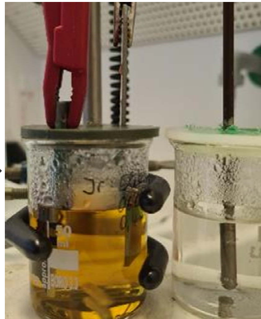
Abbildung 18 Screeningversuche zur Abscheidung von reinem Ru und Ru-Legierungen mit Iridium
