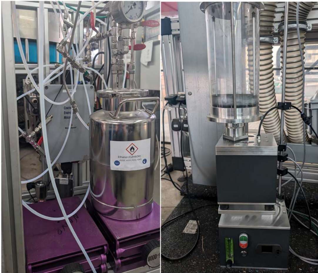
Abbildung 4: Links: Integriertes Verdampfersystem mit Spülbehälter für Lösungsmittel, Behälter für Vorläufermaterial fehlt. Rechts: Aerosolgenerator der Kamp & Kötter GmbH
