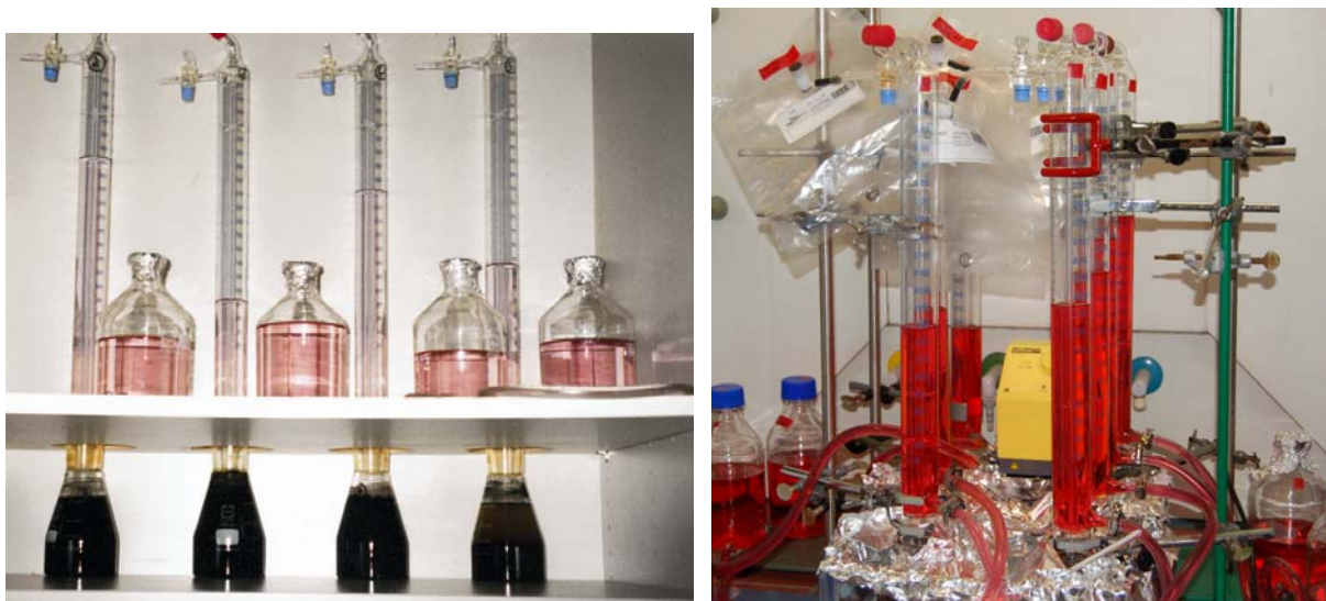
Abbildung 4.11: 500 mL Gefäße mit Eudiometern (links: UMSICHT, rechts: IUTA)
