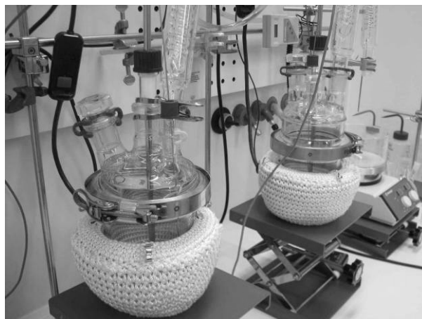
Bild 6 Versuchsaufbau zur Untersuchung des Stofftransports und der Reaktionskinetik
