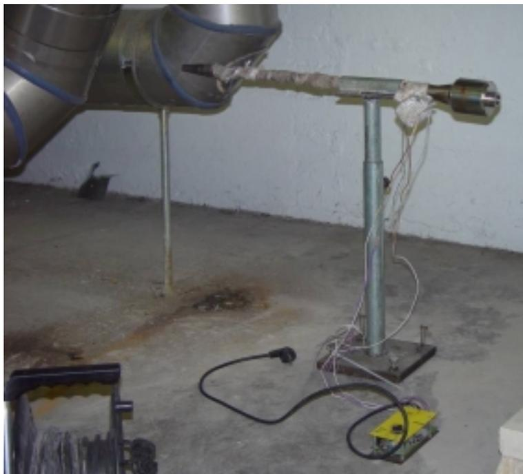
Abbildung 8 Messort Abgasrohr nach Kessel
