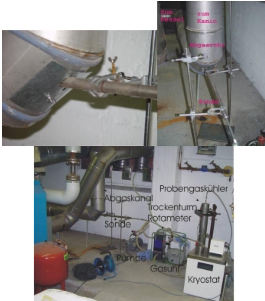
Abbildung 5 Messort Heizungsanlage: Sondenposition im Abgaskanal, Versuchaufbau
