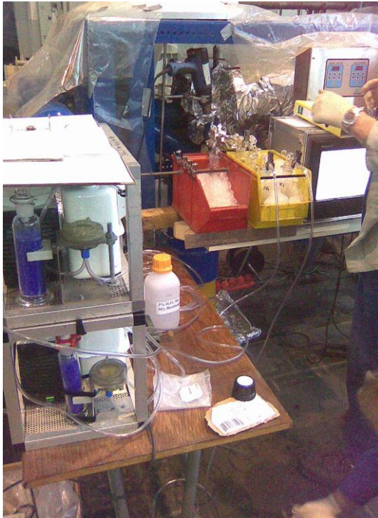
Abgaskühlung, Entfernung teerhaltiger Komponenten
