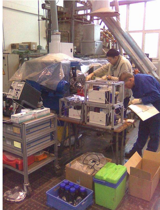
Messgeräte zur kontinuierlichen Erfassung von Summe der KW, CO 2 , CO und NO x *
