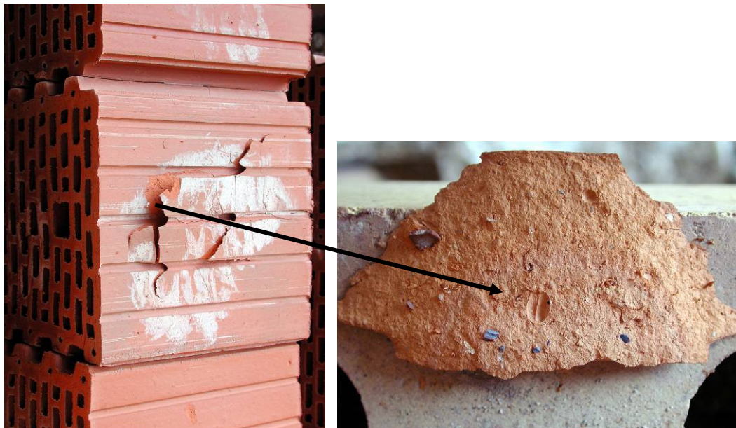
Abbildung 1 Zerstörung eines Ziegels durch die plötzliche Entgasung eines Getreidekorns
